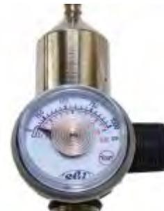
*Regulador de flujo fijado al T3 Gas Tester*
