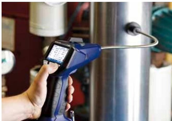
VARIANTE CON SONDA FLEXIBLE Medición de humos: A 400 / A 400i con sonda flexible
