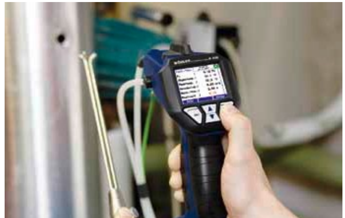
CONTROL DE CALEFACCIONES Medición de la pérdida de ventilación con el A 400 PRO / A 400i HC
