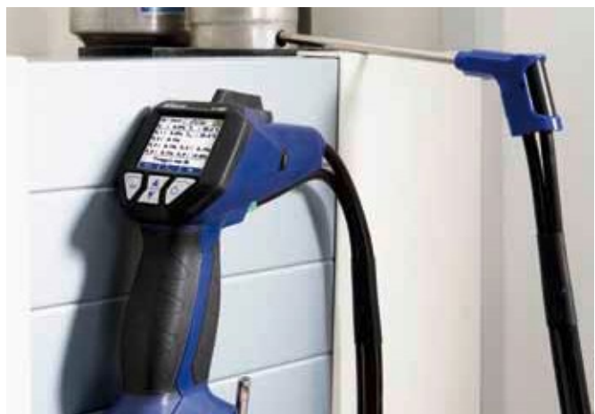
VARIANTE CON SONDA DE MANGUERA Medición de humos: A 400 PRO / A 400i HC
