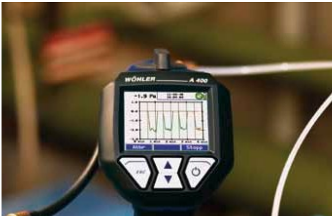
TEST 4 PA Medición 4 Pa con el A 400 PRO / A 400i HC
