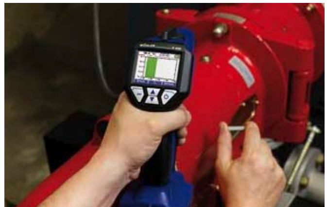
AYUDA DE AJUSTE Ayuda de ajuste para optimizar el quemador con el A 400
