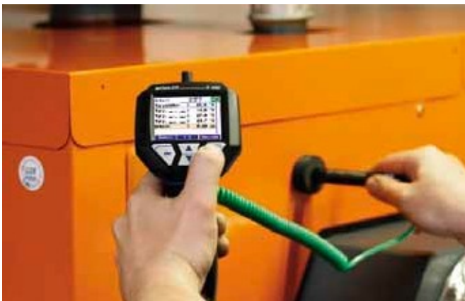
MEDICIÓN DEL VALOR U Medición de la pérdida en superficie con el A 400 PRO / A 400i HC
